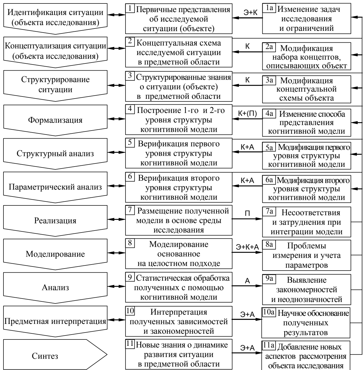
Рис. 4.1. Итеративный цикл технологии когнитивного моделирования
