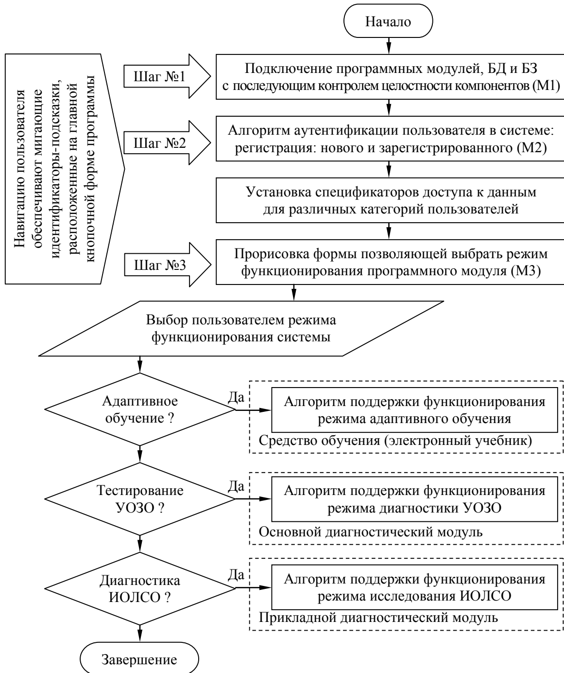
Рис. 6.2. Алгоритм переключения режимов функционирования программного комплекса
