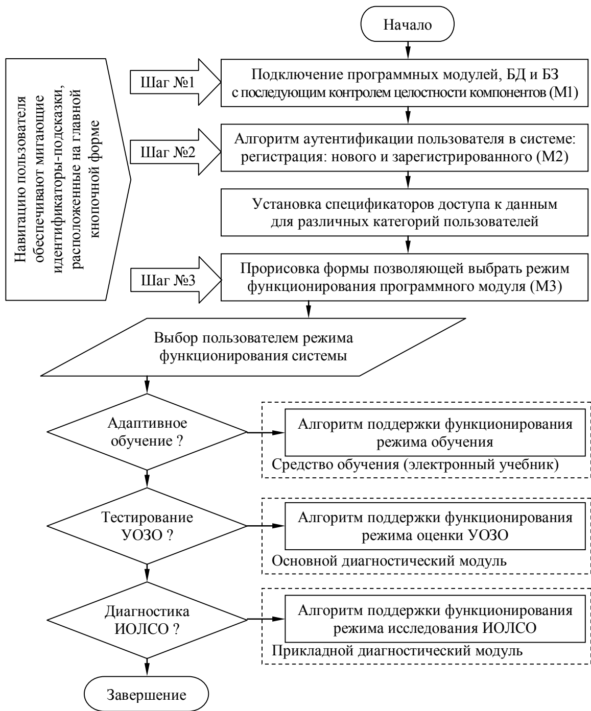
Рис. П10.10. Алгоритм переключения режимов функционирования программного комплекса
