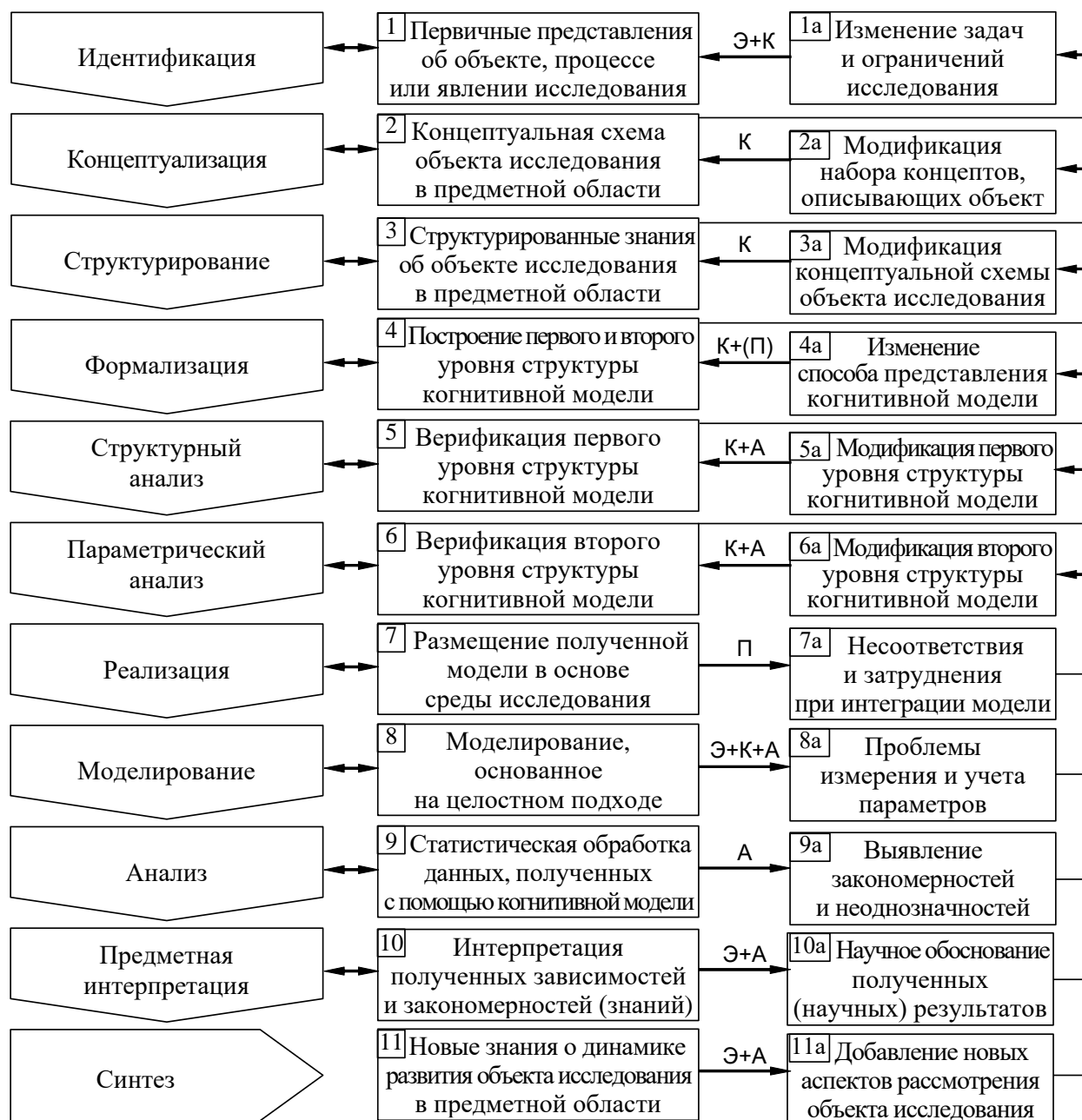
Рисунок 3.3. Итеративный цикл технологии когнитивного моделирования
