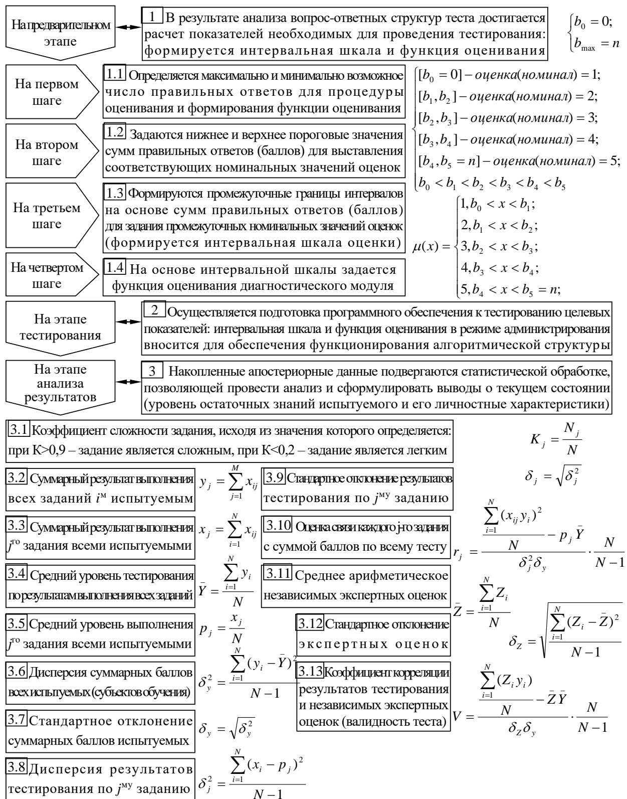
Рисунок 4.4. Алгоритм обработки апостериорных результатов тестирования
