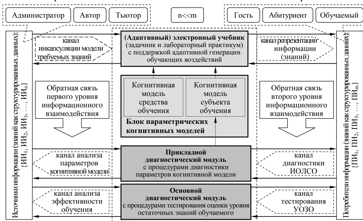
Рис. 2.3. Структура системы автоматизированного (дистанционного) обучения со свойствами адаптации на основе когнитивных моделей
