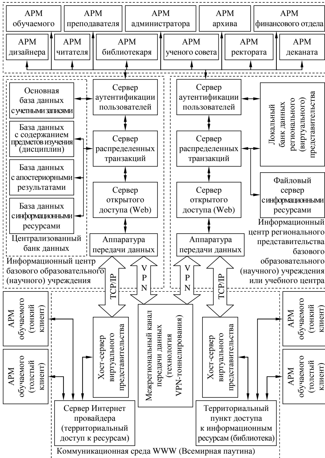
Рис. 5.5. Типовая схема взаимодействия информационного центра образовательного (научного) учреждения и автоматизированных рабочих мест субъектов обучения
