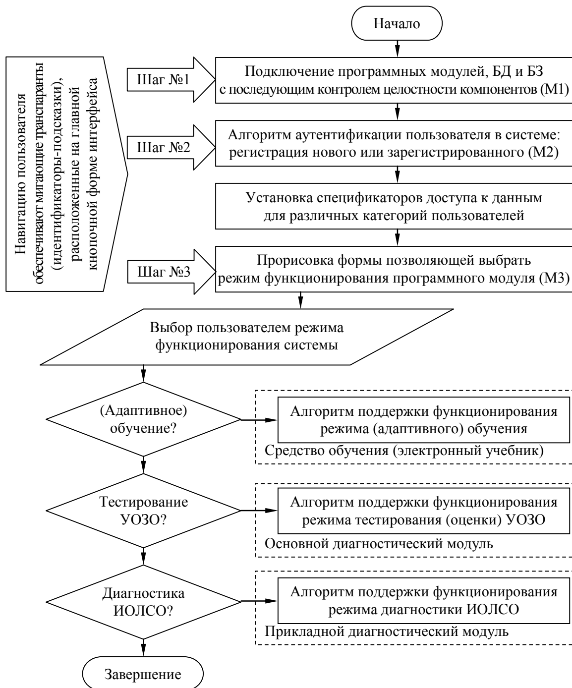
Рис. П2.11. Алгоритм переключения режимов функционирования программного комплекса: электронный учебник, основной и прикладной диагностический модуль
